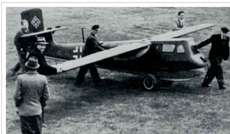
Bild 1. BV 40 i sidovy. Fästet för bogserlinan är synligt i nosen. ”Vinkelröret” på ryggen är ett pitotrör.
