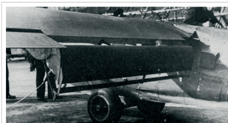
Bild 4. Vingklaffarna i maximalt nedfällt läge (80 grader). Detta användes bara i nödlägen, normalt användes 50 graders klaff vid landning. Till vänster syns inre delen av skevroddet. Kanongondolen är inte monterad, den stack annars ut en god bit bakom vingen.
